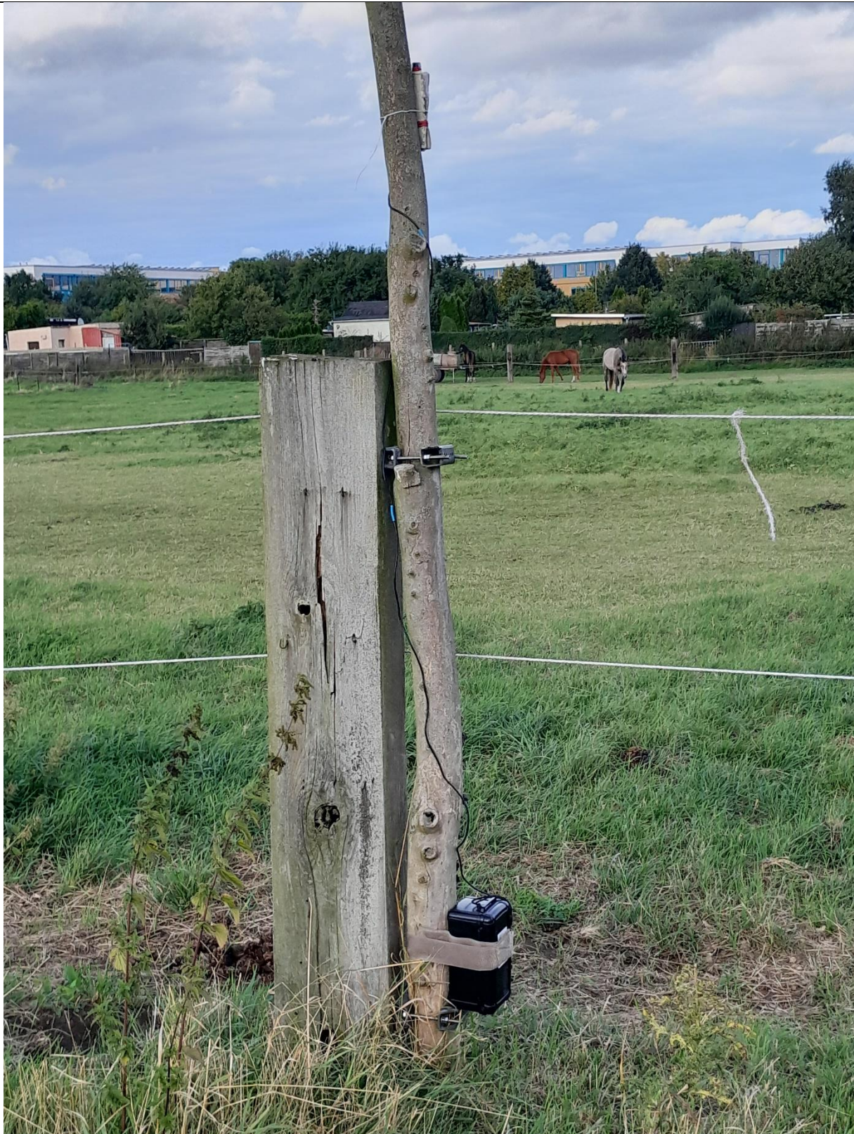
Abbildung 4: Befestigter Batcorder mit Otterbox zum Schutz von äußeren Einflüssen an Pferdekoppel am geplanten Plangebiet zum Regenrückhaltebecken.
